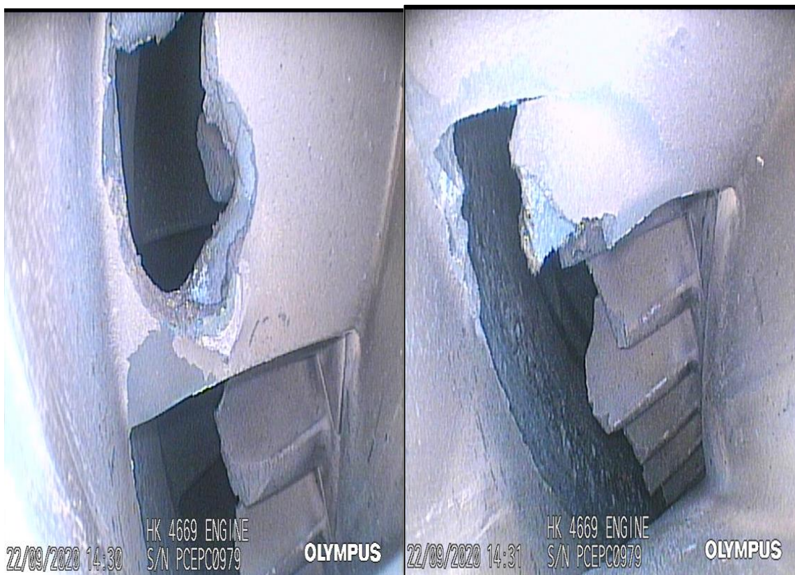
Fotografía No. 3 - Fractura de álabes al interior de la turbina de potencia.
